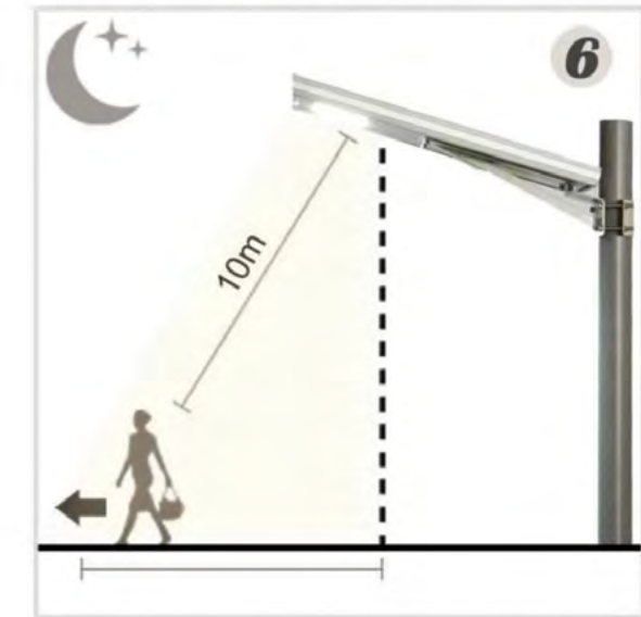
6) Cuando las personas se alejen a aprox. 10 mts del sensor de la lampara, esta disminuirá su potencia de iluminación al 20%.
